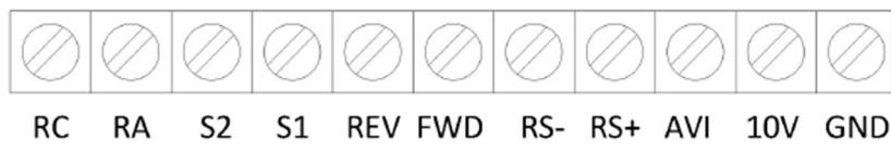
Момент затяжки винтов на клеммах - 0.2 Нм.
